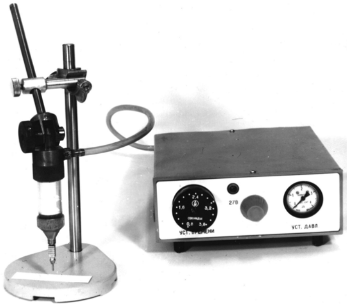
Рис. 5. 3. Пневмодозатор для дозирования паяльных паст (справа - блок управления режимами дозирования).
